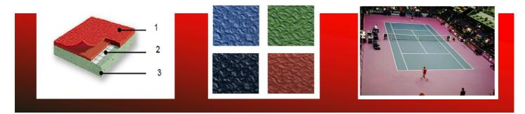
Le **TARAFLEX Tennis** est un revêtement de sol plastique constitué d'une couche de surface épaisse en vynil plastifié, calandrée et grainée, associé à une sous-couche de mousse PVC à cellules fermées, renforcé par un complexe non tissé grille en fibre de verre. Il a reçu, en cours de fabrication, un traitement Sanosol qui le rend fongistatique et bactériostatique dans toute son épaisseur.
